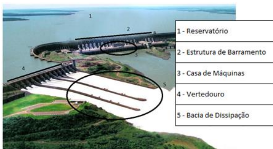
Figura 1 - Barragem de Itaipu e seus componentes. (Adaptado de Itaipu Binacional. Disponível em: < http://www.itaipu.gov.br/energia-capa >. Acesso em jun. 2014)
